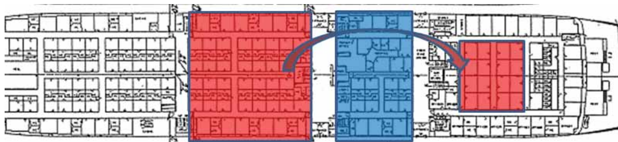
Figur 5: Viser hvordan brann 7 må ha «hoppet over» en seksjon.
