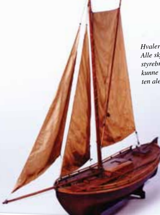
Listerbåt. Denne båttypen var på mange måter et kompromiss mellom øst- og vestnorske båter. Blant særtrekkene var et tydelig spring, stor dybde og bredde, samt skvettbord på ribbordet. Båten har spririgg med fokk og klyver, samt toppseil. Den er her rigget med garnrull for fiske. Samtidig modell i Norges Fiskerimuseum, foto Magnus Vabø.
