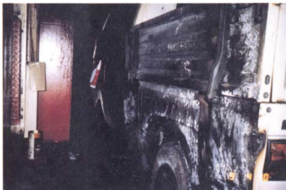
Legg merke til hvordan brannskaden slutter på bilens hjørne bak. Dette indikerer en voldsom hastighet på flammene som har truffet bilen. Foto: Olle Wennström.
