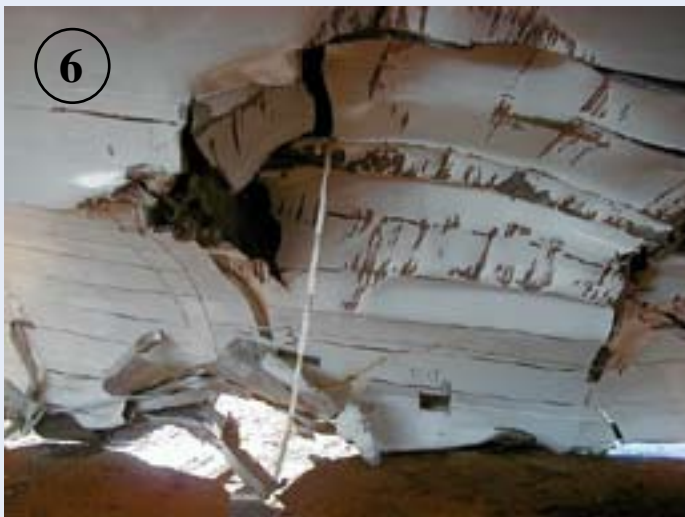
Fig. 6: Dette bildet har en historie å fortelle. Det er tatt innenfor, altså på babord side av styrbord pongtong, der tverrrammene 2, 3, og 4 er markert. Merk at vraket har en vinkel ved ramme 4, hvilket betyr at skroget er brukket også her.
