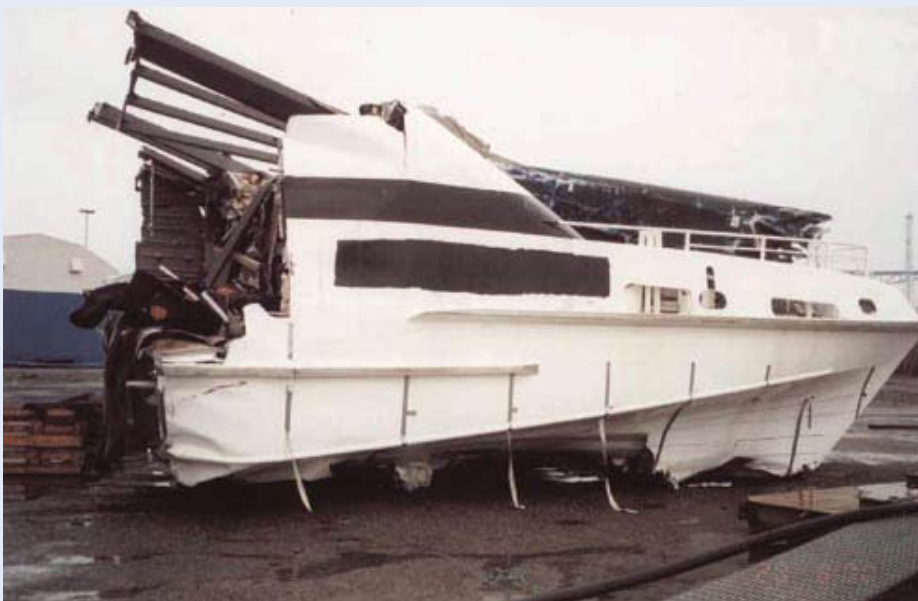
Fig. 5: Baugseksjonen, styrbord side. (Lengde ca. 11 meter). Her går det klart fram at pongtongene ikke bare er skadet, men at de er revet av skroget. Foto: Sleipner-kommisjonen.
