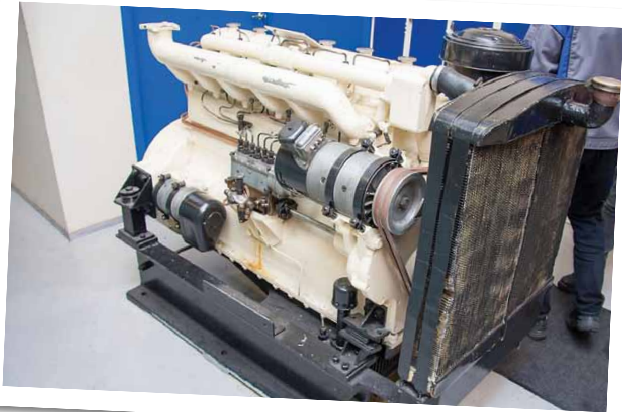
Sjelden vare, H-motoren som er vist på bildet, var tiltenkt rollen som bussmotor men ble bare produsert i 2 eksemplarer. FOTO: Bergen Engines
