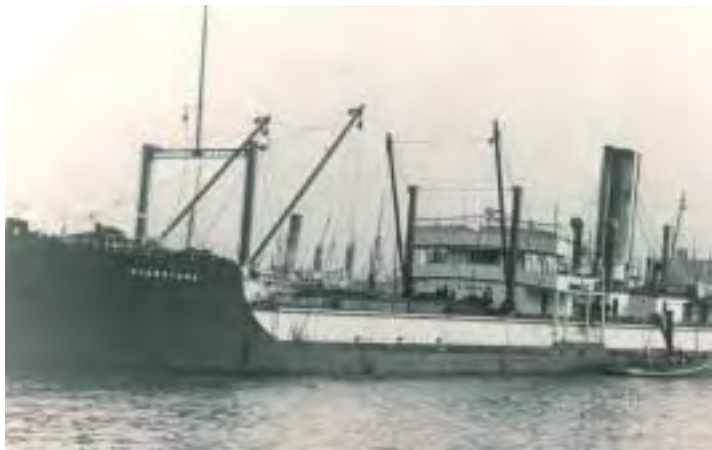
D/S Gladstone, bygget i Stockton 1909. Tilhørte Chr. Michelsen & Co. Skipet hadde et «trunk-dekk» og var beregnet for bulk-laster. Gladstone ble solgt til utlandet i 1914 (Bergens Sjøfartsmuseum).
